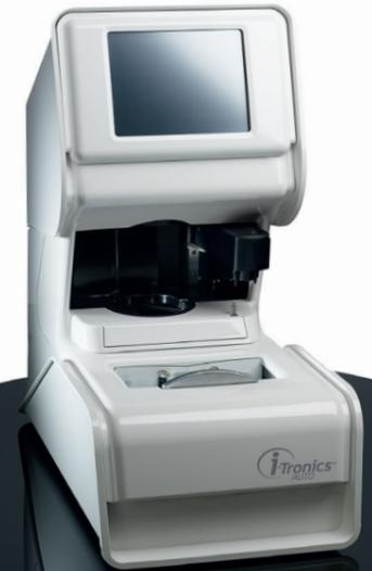
Das Abtast- und Aufblocksystem i-Tronics ist gezielt auf Präzision und Anwendungskomfort ausgelegt. Dafür sorgen zwei Optionen - manuelle oder vollautomatische Glaszentrierung. Beide Systeme übernehmen alle Schritte der Glasbearbeitung und können mit den Schleifeinheiten der Reihe i-Tronics nahtlos in einen durchgängigen Prozess eingebunden werden.
